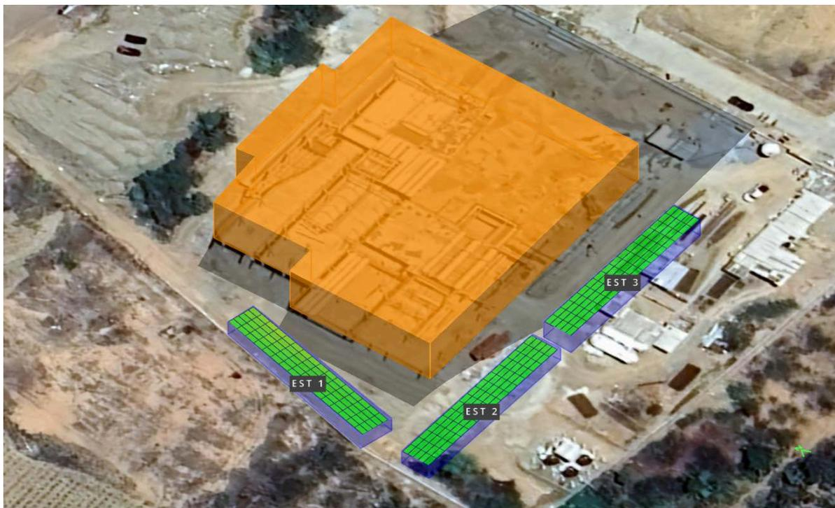
**Figura 2:** Simulação tridimensional das áreas disponíveis para instalação dos módulos fotovoltaicos.
